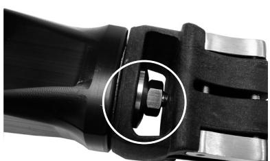
Na gwinty śrub nanieść klej Loctite 243. Zamontować dystalną obudowę górną, przykręcając nakrętkę i podkładkę, jak przedstawiono to na rysunku, i dokręcić momentem 35 Nm po wyosiowaniu.
