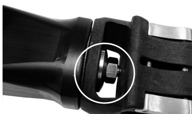
Aplique Loctite 243 nas rosas das parafusos. Monte a estrutura superior distal com a porca e a anilha, conforme ilustrado, e aplique um binário de aperto de 35 Nm após o alinhamento.
