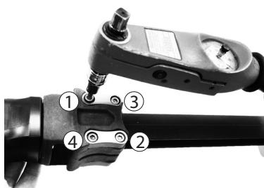
Draai de klemsschroeven gelijkmatig vast, met een moment van 5 Nm, ten minste twee keer per schroef. Weergegeven voorbeeld van de volgorde van het aandraaien voor een gelijkmatig verspreide belasting.
