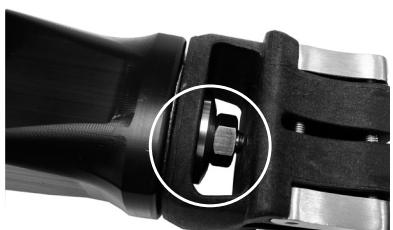
Aplicar Loctite 243 a las roscas de los tornillos. Montar la carcasa superior distal con la tuerca y la arandela como se muestra en la ilustración y, tras alinearlas, apretar hasta un par de 35 Nm.
