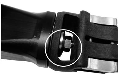
Tragen Sie Loctite 243 auf die Schraubengewinde auf. Bauen Sie das distale Obergehäuse mithilfe der Mutter und Unterlegscheibe wie dargestellt auf, und ziehen Sie es nach der Ausrichtung mit 35 Nm fest.
