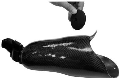
Fabriquez l'emboîture à l'aide du gabarit à boulon unique Blatchford approprié. Découpez un trou de 27 mm de diamètre dans l'extrémité distale de l'emboîture. Placez la plaque d'emboîture à l'intérieur de l'emboîture. Assemblez les pièces d'alignement fournies. Épaisseur minimale de l'emboîture : 6 mm.
