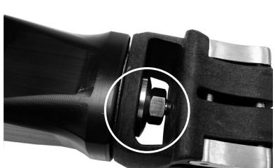
Applicare Loctite 243 alle filettature dei bulloni. Assemblare l'alloggiamento distale superiore utilizzando il dado e la rondella come illustrato e serrare a 35 Nm dopo aver eseguito l'allineamento.
