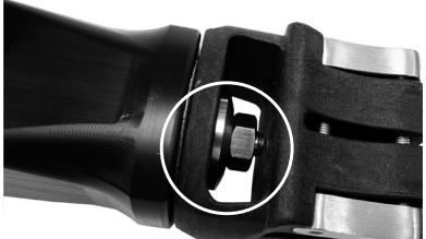
Appliquez du Loctite 243 sur les filets des boulons. Assemblez le boîtier supérieur distal à l'aide de l'écrou et de la rondelle comme indiqué et serrez au couple de 35 Nm après alignement.
