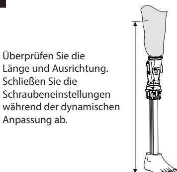
Überprüfen Sie die Länge und Ausrichtung. Schließen Sie die Schraubeneinstellungen während der dynamischen Anpassung ab.
