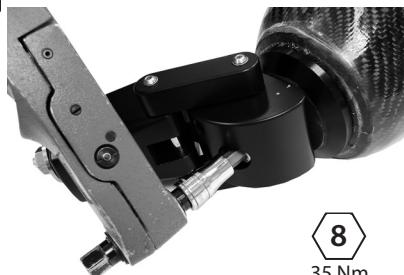
Tragen Sie Loctite 243 auf, und ziehen Sie die proximale Ausrichtungsschraube mit 35 Nm fest. Verwenden Sie einen Stiftschlüssel (940060), um eine Drehung der Schaftplatte zu verhindern.
