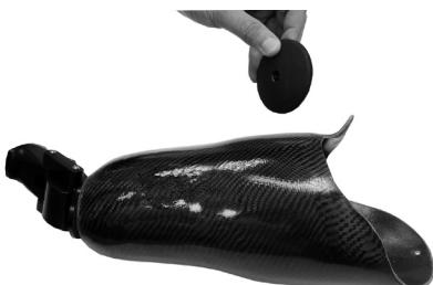
Stellen Sie den Schaft mit einem angemessenen Einzelschraubenformer von Blatchford her. Schneiden Sie ein Loch mit einem Durchmesser von 27 mm in das distale Ende des Schaftes. Platzieren Sie die Schaftplatte in dem Schaft. Bauen Sie die mitgelieferten Ausrichtungsteile zusammen. Minimale Schaftdicke: 6 mm.
