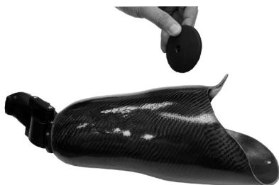
Fabbricare l'invasatura utilizzando lo stampo monovite Blatchford adeguato. Praticare un foro di 27 mm di diametro all'estremità distale dell'invasatura. Collocare la piastra dell'invasatura all'interno dell'invasatura stessa. Assemblare i componenti di allineamento forniti. Spessore minimo della guaina: 6 mm.
