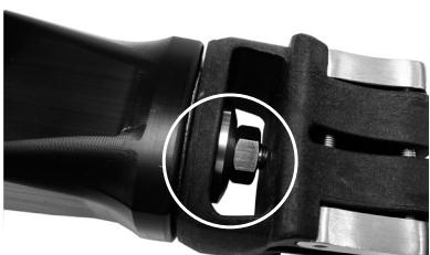
Na závity šroubů naneste Loctite 243. Smontujte distální horní kryt pomocí matice a podložky, jak je znázorněno, a po vyrovnání utáhněte momentem 35 Nm.
