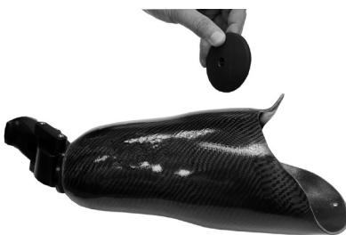
Vyrobněte objímku pomocí vhodné formovací formy Blatchford s jedním šroubem. Na distálním konci objímky vyřízněte otvor o průměru 27 mm. Vložte desku objímky do objímky. Sestavte dodané vyrovnávací díly. Minimální tloušťka objímky 6 mm.
